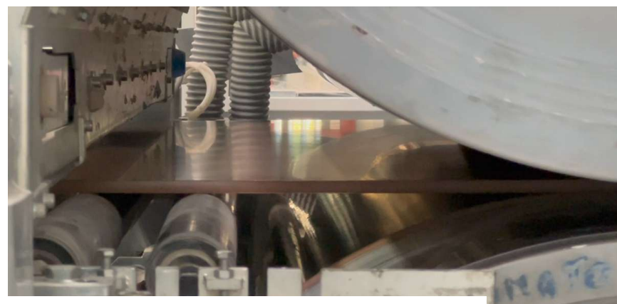
Figura 4 - lastra pressata in uscita dalla macchina
